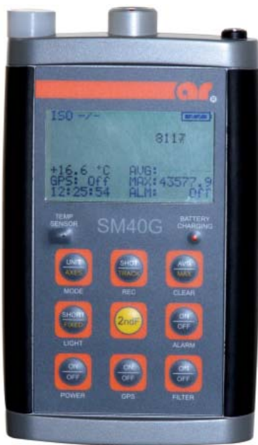
Das breitbandige Feldstärke-Messgerät SM40G.
